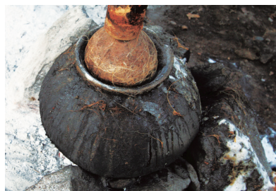
写真 3-22 立ち上がり竹管と冷却竹管からなる装置をセットする。
