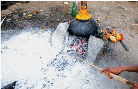
写真 3-27 蒸気漏れをチェックしながら、熾を加えて加熱する。
