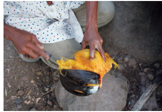
写真3-10 ロンタールヤシ中果皮の密封用充填材
