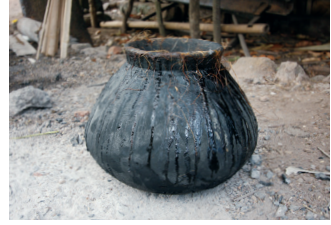
写真3-8 蒸留釜の土器壺
