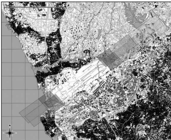
図4 嘉手納飛行場へのAICUZの当てはめ(海側のCPZ2は省略) 執筆者作成
