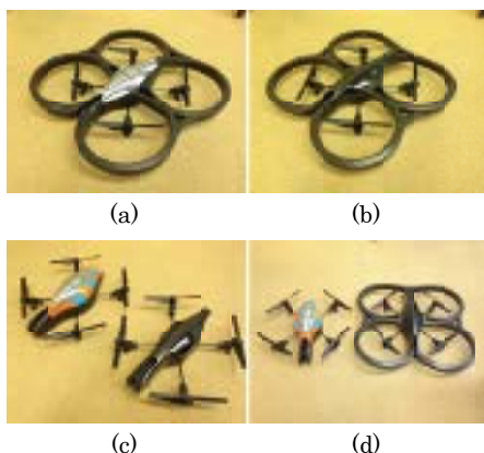
図1 UAV (AR.DroneとAR.Drone 2.0) 外観 (a)AR.Drone (屋内用ハル装着), (b)AR.Drone 2.0 (屋内用ハル装着), (c)AR.Drone [写真左]とAR.Drone 2.0 [写真右] (屋外用ハル装着), (d)屋外用ハル [写真左]と屋内用ハル [写真右]
