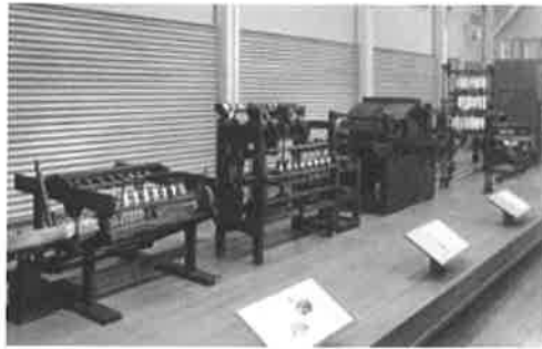
(写真-2 初期の紡績機械 左からジェニー紡績機、ウォーターフレーム精紡機、ミュール紡績機)
